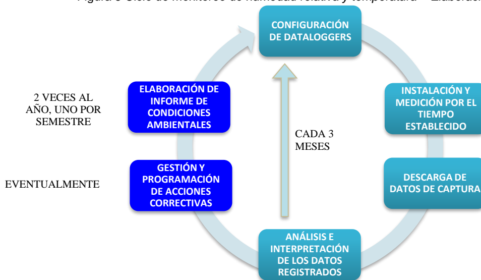
Figura 5 Ciclo de monitoreo de humedad relativa y temperatura – Elaboración propia
